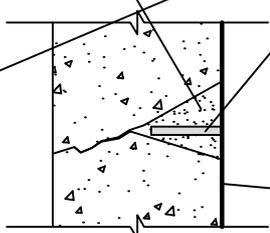
Г) Ликвидация протечки и вертикальная гидроизоляция
