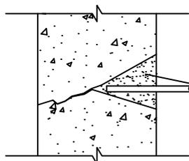
В) Установка дренажной трубки
